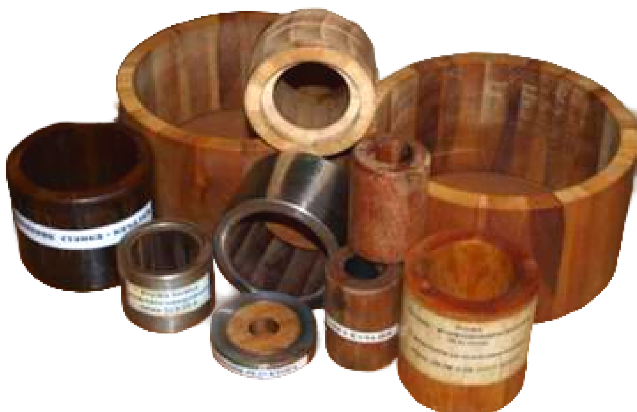
Подшипники скольжения изготовлены из модифицированной древесины деста́м
